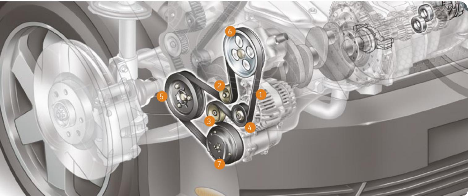
Система привода вспомогательных агрегатов обеспечивает передачу крутящего момента для ряда узлов, таких как генератор, компрессор кондиционера, насос гидроусилителя рулевого управления, а в некоторых случаях и для водяного насоса.
