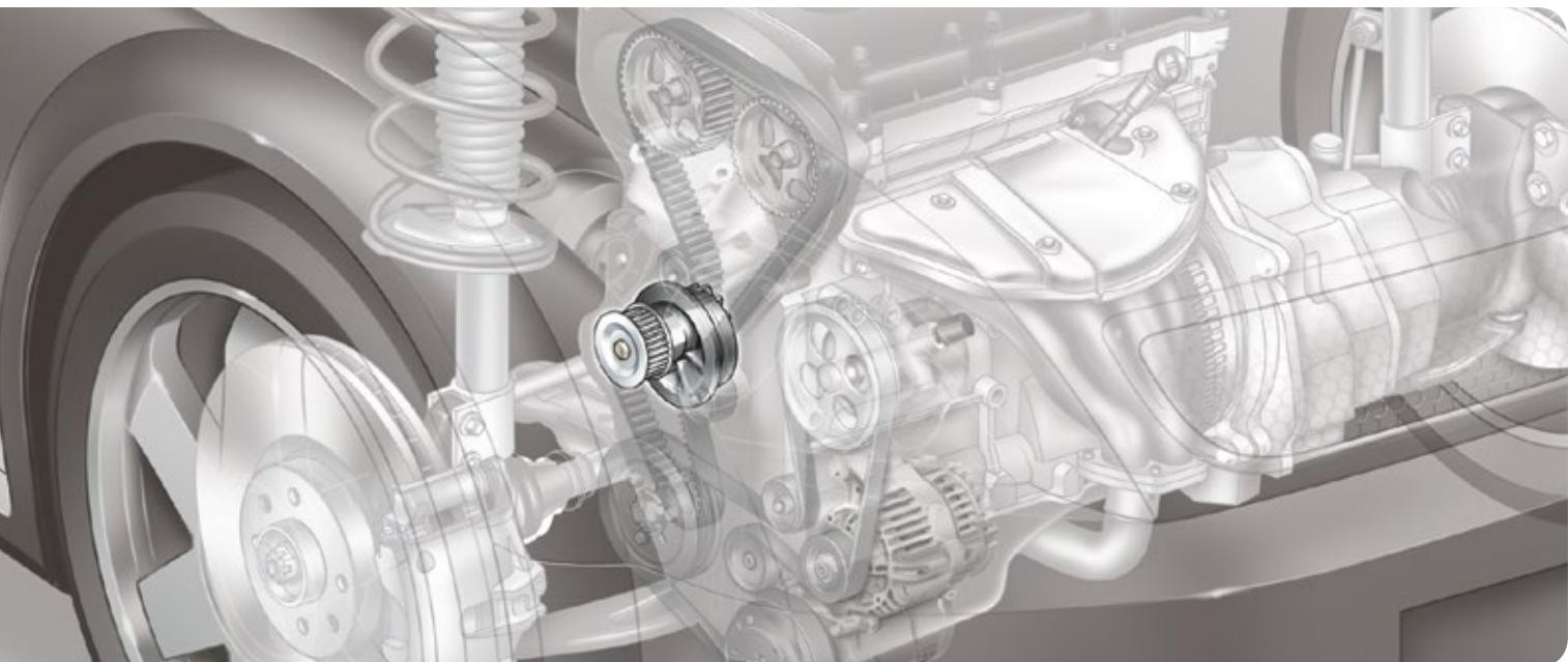
Водяной насос (обычно центробежный насос с ременным приводом) является сердцем автомобильной системы охлаждения. Насос обеспечивает циркуляцию охлаждающей жидкости в системе для поддержания оптимальной температуры двигателя во время его работы.
