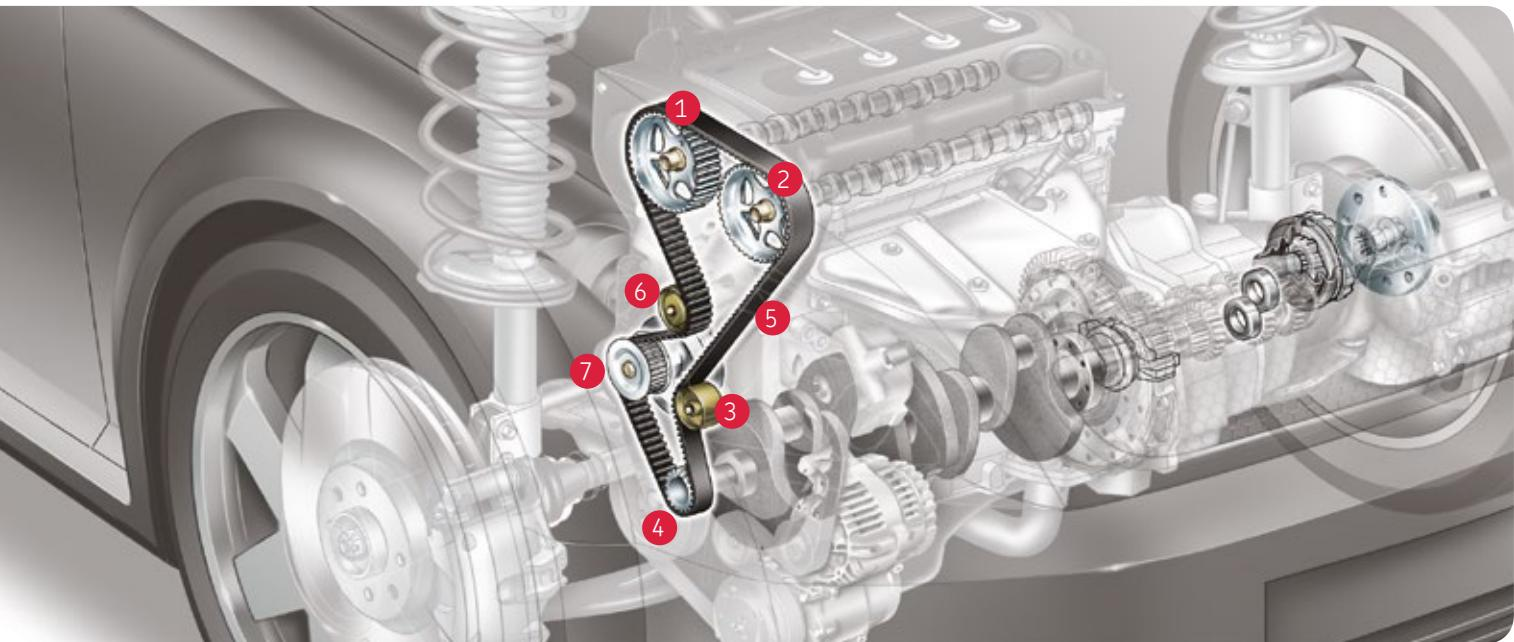
Привод газораспределительного механизма (ГРМ) является важной частью четырёхтактного двигателя внутреннего сгорания, его компоненты обеспечивают синхронизированное вращение коленчатого и распределительного (-ых) валов, а также своевременное открытие и закрытие впускных и выпускных клапанов двигателя. В большинстве случаев ремень или цепь ГРМ передают усилие от коленчатого вала, необходимое для вращения распределительного (-ых) вала (-ов).
