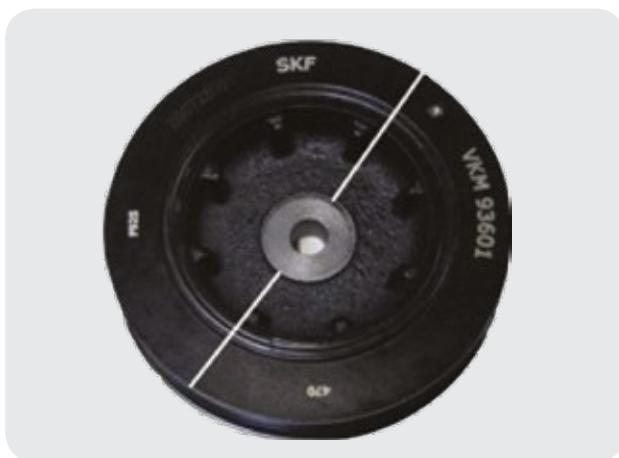
Рис. 1 - Демпфер перед разгоном до 3000 об/мин
