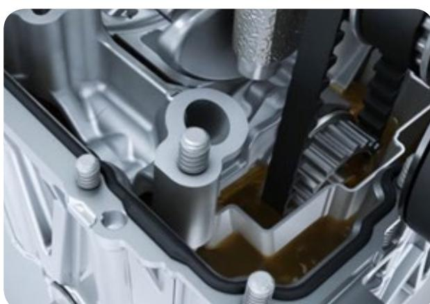
**Важно:** двигатели со смазываемым ремнем требуют применения моторных масел с особыми характеристиками и проведения работ по техническому обслуживанию согласно графику. Только при этих условиях достигается максимальный срок службы ремня ГРМ такого типа! Страйгите рекомендациям производителя автомобиля.
