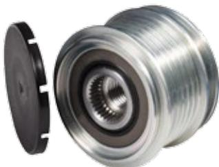
Шкив генератора с муфтой свободного хода снижает вибрацию в системе привода вспомогательных агрегатов, тем самым обеспечивая надёжную и долговечную работу поликлинового ремня и всех компонентов системы. Он также позволяет экономить энергию, используя кинетическую энергию быстро вращающегося генератора, когда обороты двигателя внезапно падают.
